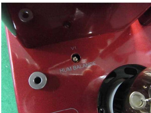
アンプ本体にスピーカーを繋いで、何も音声入力を入れない状態で、ボリュームも完全に絞った状態で、スピーカーから聴こえてくる「ブーン」というハムノイズ音が一番小さくなるように「HUM BALANCE」トリマを回して調整します。
