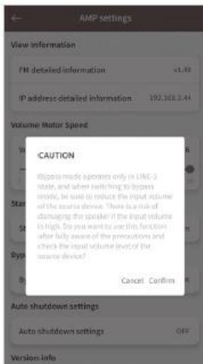
バイパスロックの設定を行う際は必ずアンプの電源を切ってから行って下さい。
