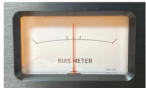
※ご注意 : バイアス調整は電源を入れてから 15 分程度経過し、真空管の動作が安定してから行ってください。また、調整後しばらく動作させてから、2 本の真空管それぞれのバイアス値を再確認してください。
